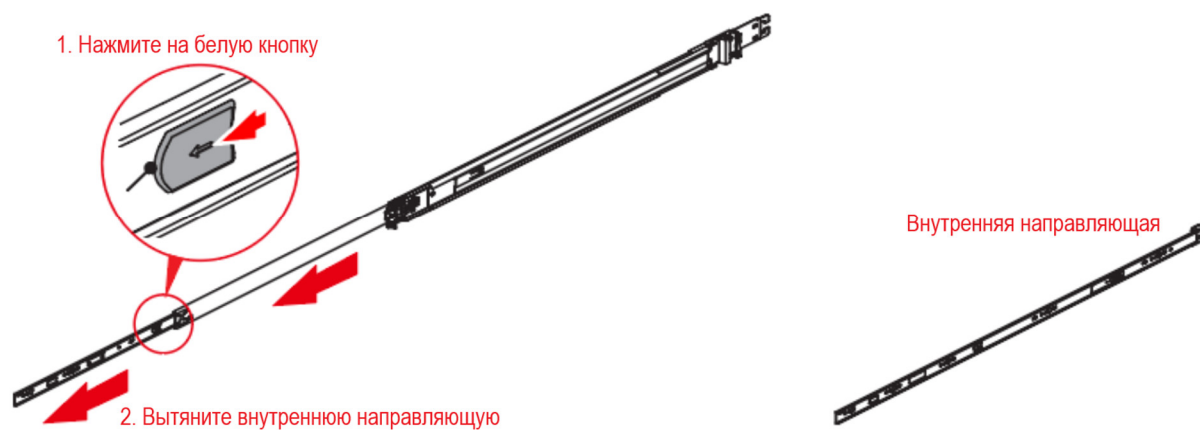
Рисунок 3. Разблокировка внутренней направляющей
